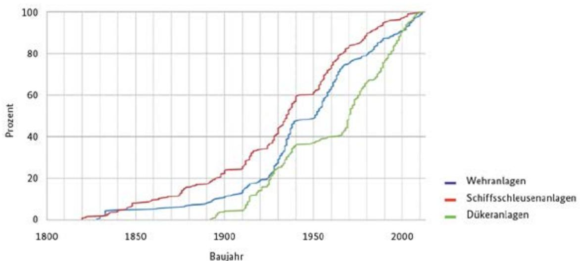
Abbildung 11: Altersstruktur ausgewählter Anlagen an den Bundeswasserstraßen
