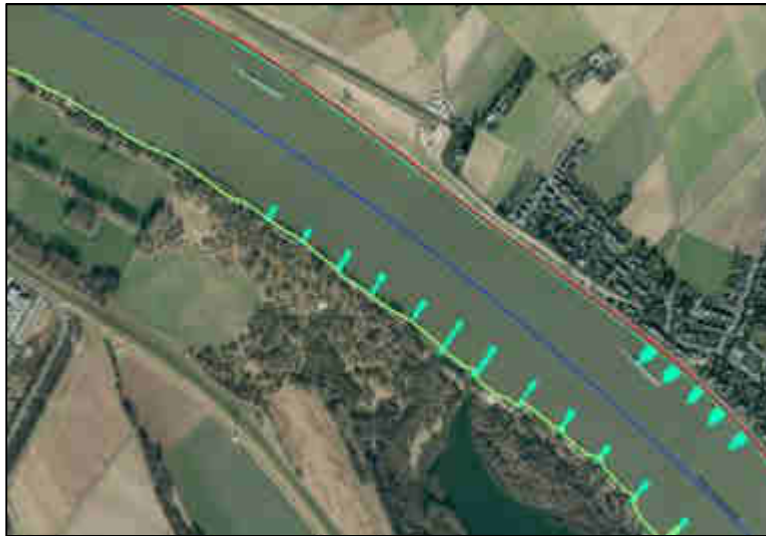
Abbildung 3.3.3 Beispiel für die Ermittlung von Gewässerverbau; hier: Ufersicherung und Buhnen (türkis) auf Grundlage der IENC an der Mittelweser (linkes Ufer = grün, rechtes Ufer = rot).
